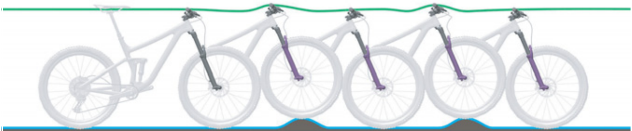
Figura 88: Condición óptima de marcha de la horquilla
