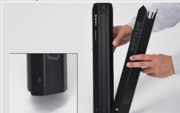
Figura 43: Desplazamiento de la cubierta de la batería sobre la batería
