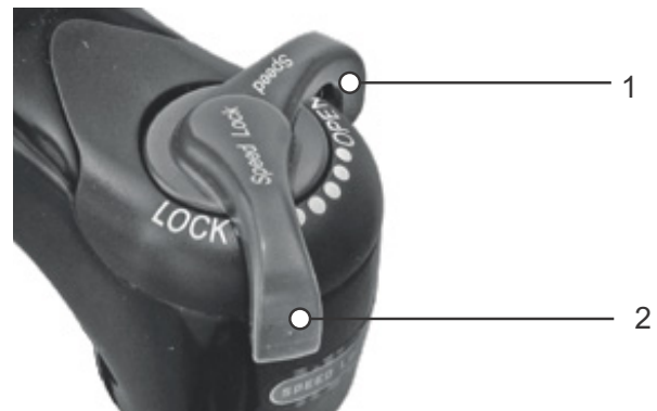
Figura 122: Amortiguador de niveles de presión Suntour en posición abierta (1) y cerrada (2)
