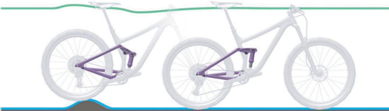
Figura 98: Condición óptima de marcha del amortiguador de la horquilla trasera en caso de irregularidades
