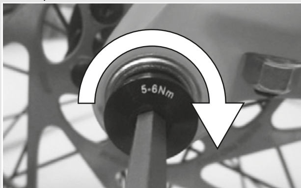
Figura 51: Apriete del tornillo de seguridad
