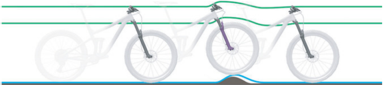
Figura 140: Amortiguación de la horquilla de suspensión demasiado dura en caso de irregularidades
