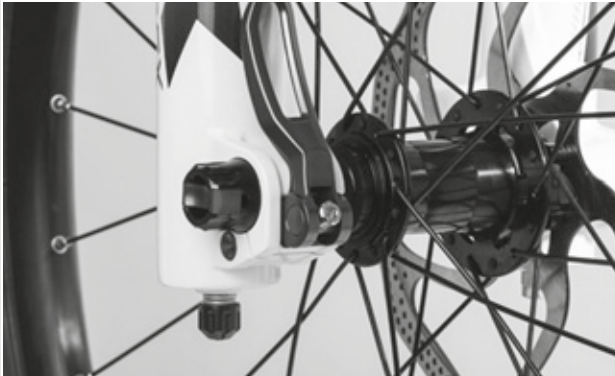
Figura 129: Ajuste de la fuerza de tensado del cierre rápido
