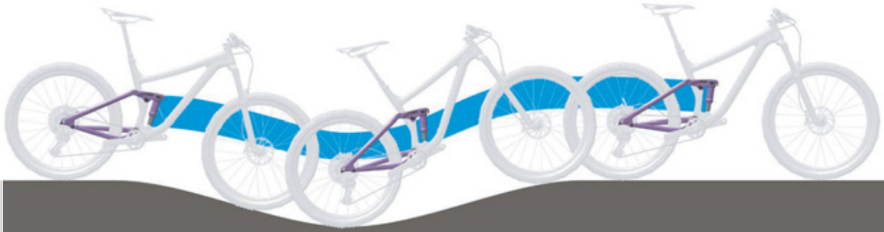
Figura 97: Condición óptima de marcha del amortiguador de la horquilla trasera sobre un terreno accidentado
