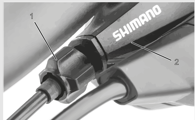
Figura 131: Casquillo de ajuste (1) del cambio de marchas accionado por cable de accionamiento con carcasa de la palanca de cambio (2), ejemplo
