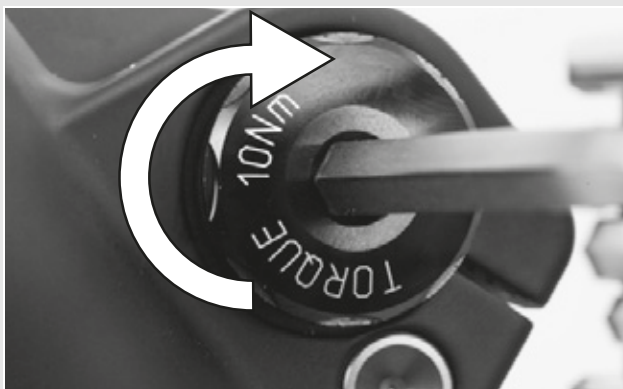
Figura 52: Apriete del eje insertado
