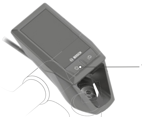
Figura 113: Posición del botón de conexión/desconexión (ordenador de a bordo)
