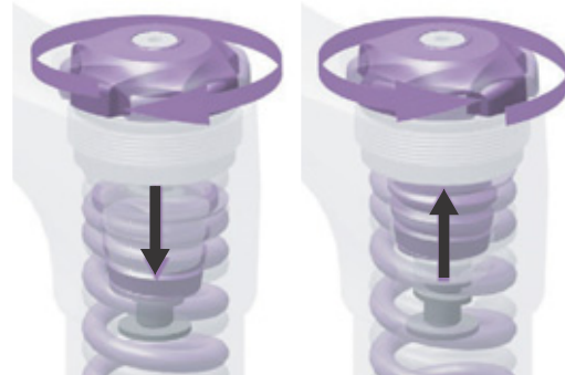
Figura 82: Enroscado y desenroscado del anillo de ajuste de la tensión previa
