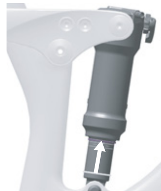
Figura 87: Desplazamiento de la junta tórica en el amortiguador de la horquilla trasera
