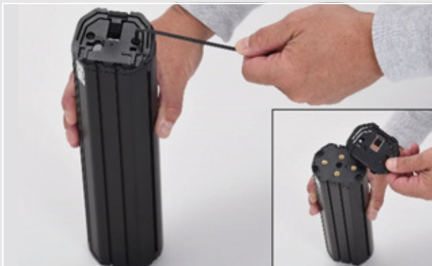
Figura 44: Desmontaje de la interfaz superior
