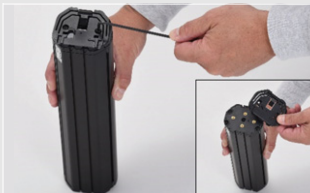
Figura 41: Desmontaje de la interfaz superior
