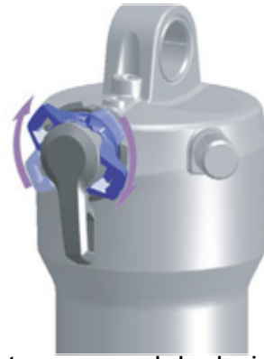
Figura 100: Ajuste para un regulador de niveles de presión más duro
