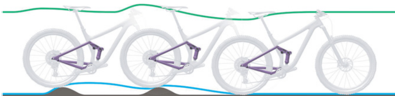
Figura 144: Descompresión demasiado lenta del amortiguador de la horquilla trasera
