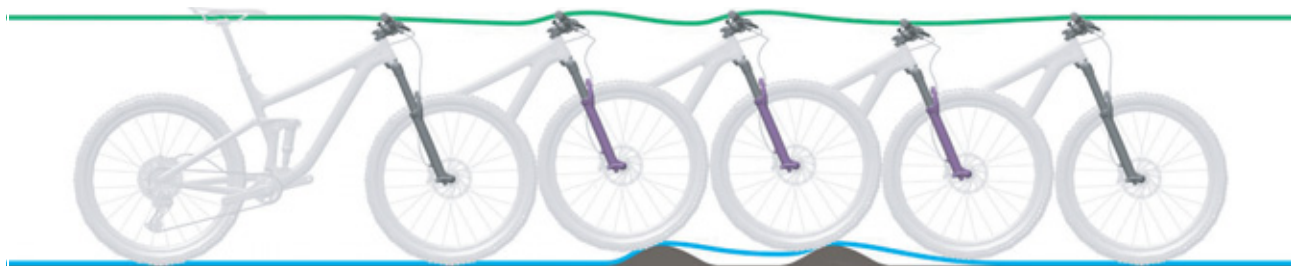
Figura 136: Descompresión demasiado lenta de la horquilla de suspensión
