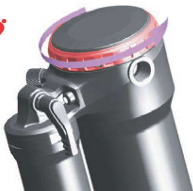
Figura 145: Giro del amortiguador de niveles de tracción en dirección al conejo
