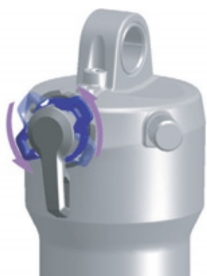
Figura 149: Ajuste para un regulador de niveles de presión más blando
