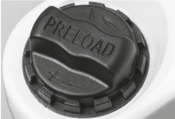
Figura 79: Rueda de ajuste SAG en la corona de la horquilla de suspensión
