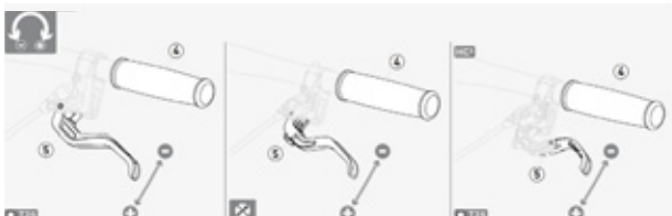
Figura 77: Ajustar el ancho de agarre de la palanca de freno con freno de disco Magura
