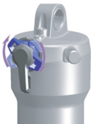
Figura 147: Ajuste para un regulador de niveles de presión más duro
