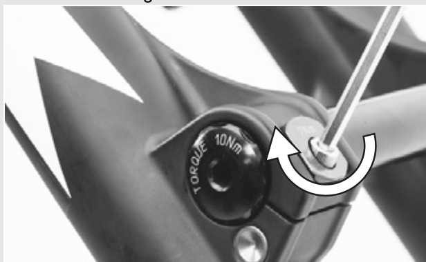
Figura 53: Apretar la abrazadera de sujeción
