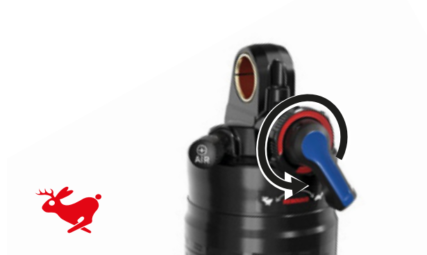
Figura 96: Incremento de la velocidad de descompresión
