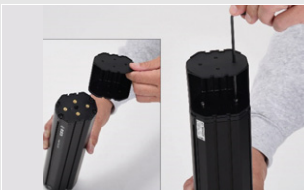
Figura 45: Montaje de la prolongación de la PowerTube
