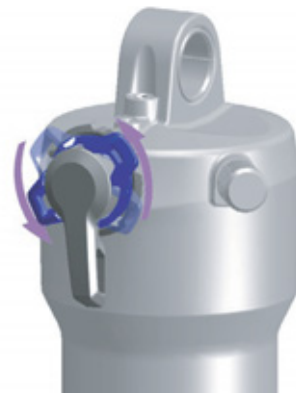
Figura 101: Ajuste para un regulador de niveles de presión más blando
