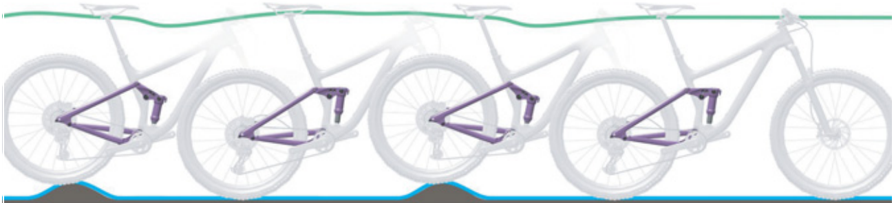
Figura 10: Condición óptima de marcha del amortiguador de la horquilla trasera
