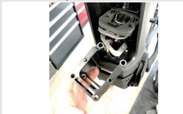
Figura 38: Extracción del adaptador PowerTube
