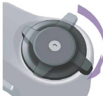
Figura 123: Ajuste para un regulador de niveles de presión más duro
