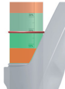
Figura 85: Rango SAG especificado (verde) y rango SAG prohibido
