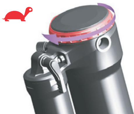
Figura 143: Giro del amortiguador de niveles de tracción en dirección a la tortuga
