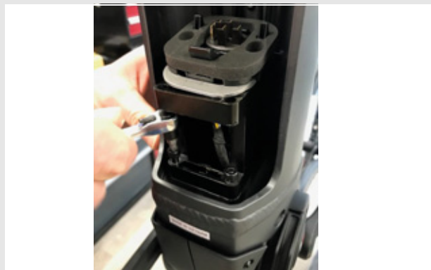
Figura 36: Retirada de los tornillos hexagonales de 4 mm
