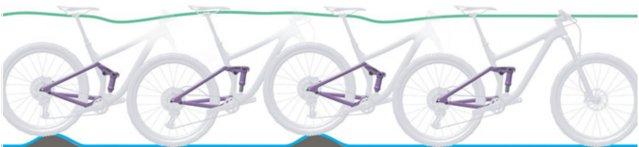
Figura 89: Condición óptima de marcha del amortiguador de la horquilla trasera
