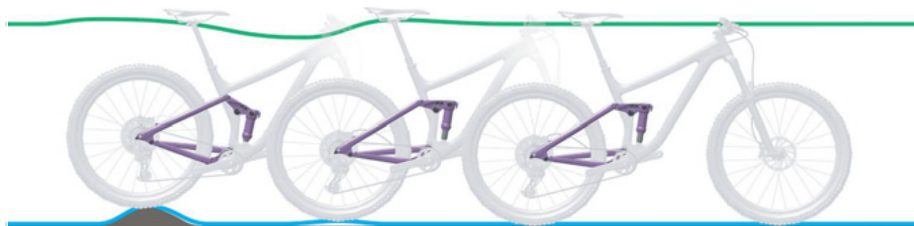
Figura 142: Descompresión demasiado rápida del amortiguador de la horquilla trasera
