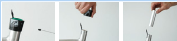
Rysunek 120: Demontaż tulei zewnętrznej i tulei ślizgowej
