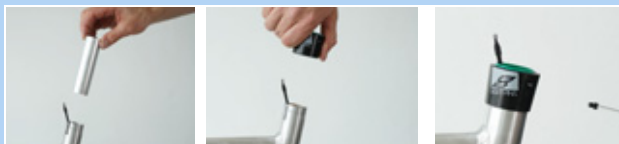
Rysunek 136: Montaż tulei ślizgowej i tulei zewnętrznej
