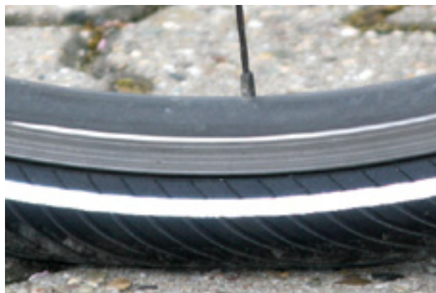
Rysunek 62: Prawidłowe ciśnienie w oponach. Opona prawie nie odkształca się pod wpływem ciężaru ciała
