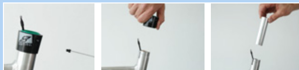
Rysunek 154: Demontaż tulei zewnętrznej i tulei ślizgowej
