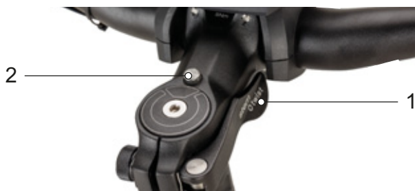
Rysunek 87: Mostek, wersja II z dźwignią mocującą zacisku szybko mocującego (1) mostka i przyciskiem odblokowującym (2)
