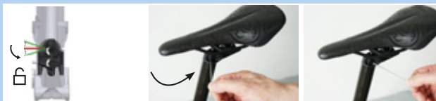
Rysunek 112: Ustawianie mechanizmu regulacji wysokości w pozycji „otwartej”.
