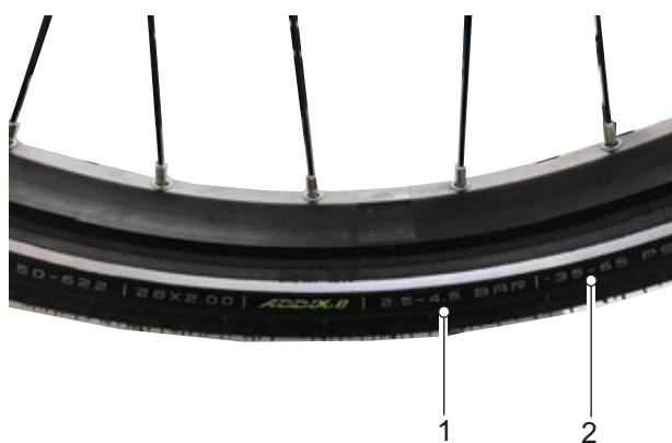
Rysunek 98: Ciśnienie w oponach w barach (1) i psi (2)
