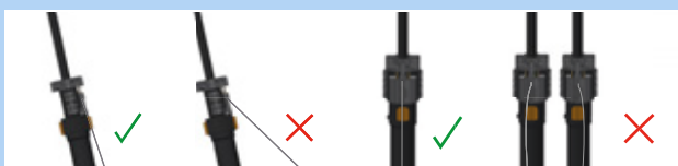
Rysunek 139: Prawidłowa i nieprawidłowa pozycja cięgna Bowdena
