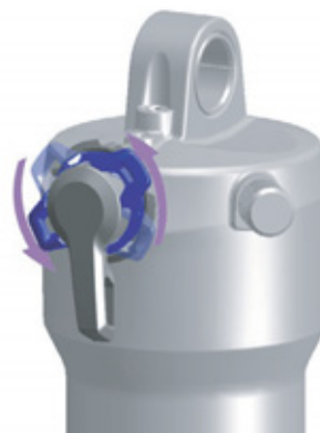
Rysunek 101: Ustawienie nastawnika dobicia na bardziej miękki tryb pracy
