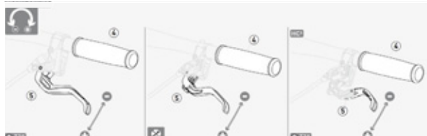
Rysunek 77: Ustawianie odchylenia manetki dźwigni hamulca tarczowego Magura
