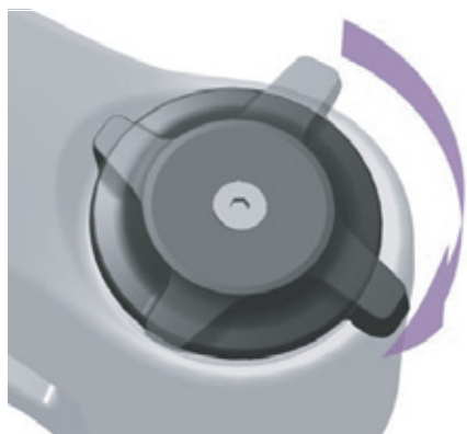
Rysunek 139: Ustawienie nastawnika dobiecia na twardszy tryb pracy
