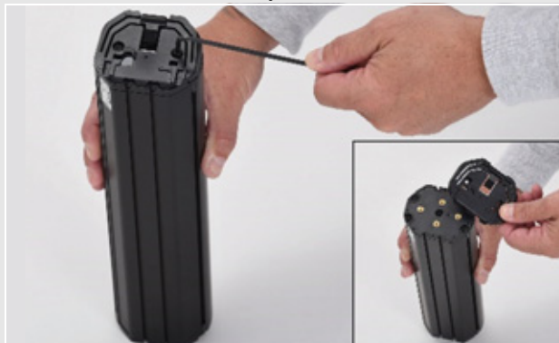
Rysunek 44: Demontaż górnego interfejsu
