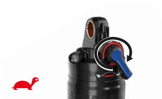
Rysunek 95: Zmniejszanie szybkości rozprężania
