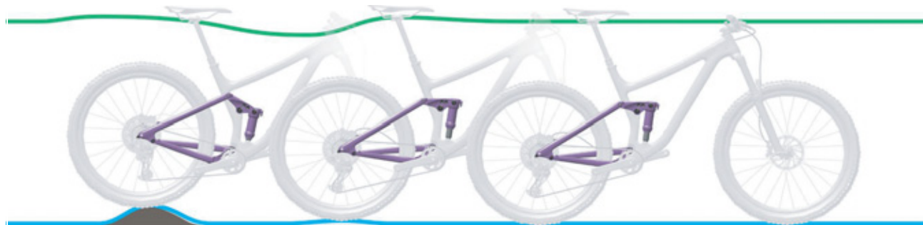
Rysunek 142: Zbyt szybkie rozprężanie się tylnego amortyzatora
