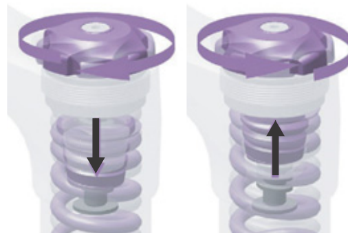
Rysunek 82: Przykręcanie i odkręcanie pierścienia regulacji naprężenia wstępnego.
