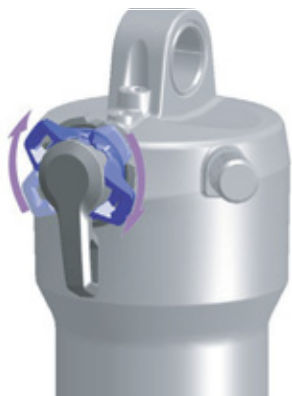
Rysunek 147: Ustawienie nastawnika dobiecia na twardszy tryb pracy
