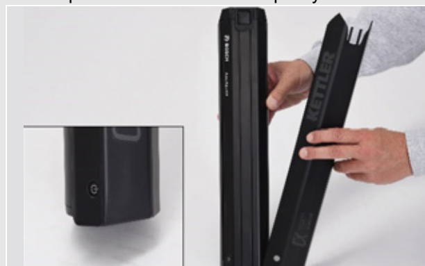
Rysunek 43: Wsuwanie pokrywy na akumulator
