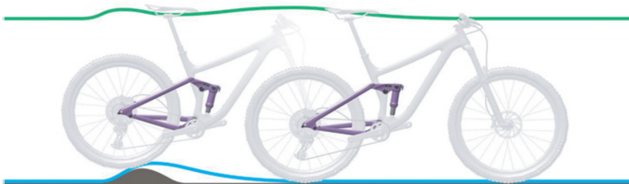
Rysunek 148: Zbyt twarde tłumienie tylnego amortyzatora na nierównościach
