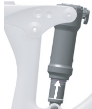
Rysunek 87: Przesuwanie pierścienia o-ring na tylnym amortyzatorze
