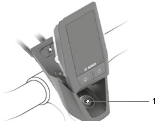
Rysunek 111: Usytuowanie śruby zespołu sterowania
