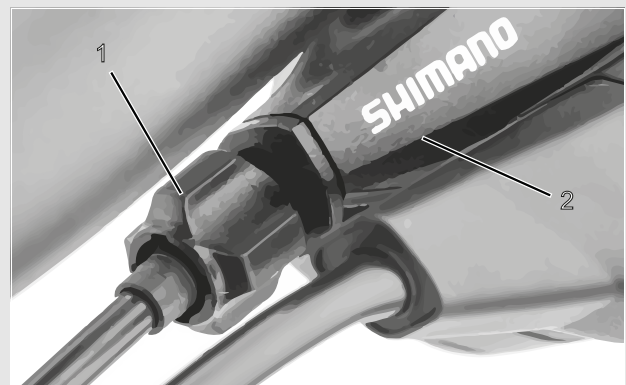
Rysunek 131: Nakrętka regulacyjna (1) jednościęnowego mechanizmu zmiany przerutek z obudową dźwigni zmiany biegów (2), przykład
