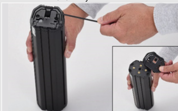
Rysunek 41: Demontaż górnego interfejsu
