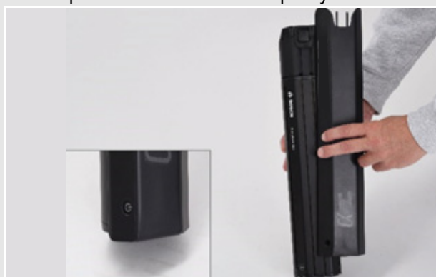
Rysunek 47: Wsuwanie pokrywy na akumulator
