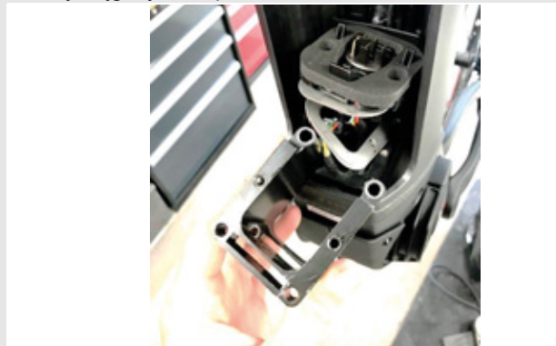
Rysunek 38: Wyciąganie adaptera PowerTube
