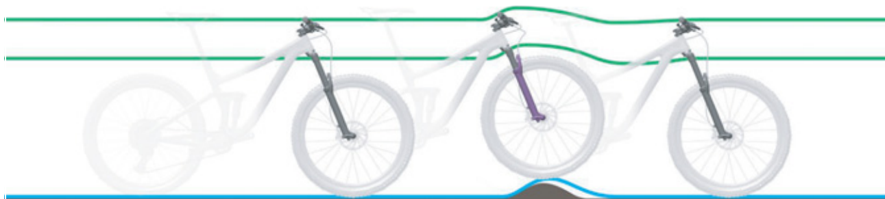
Rysunek 140: Zbyt twarde tłumienie widelca amortyzowanego na nierównościach
