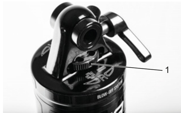
Rysunek 91: Nastawnik odbicia koła Suntour (1) na tylnym amortyzatorze
