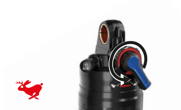
Rysunek 96: Zwiększanie szybkości rozprężania
