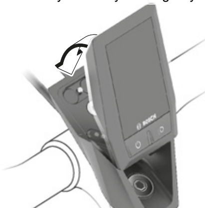
Rysunek 110: Zatrzaskiwanie komputera pokładowego
