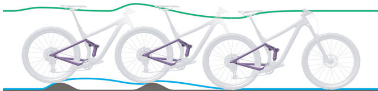
Rysunek 144: Zbyt wolne rozprężanie się tylnego amortyzatora
