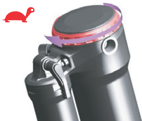
Rysunek 143: Obrócić pokrętko amortyzatora odbicia w kierunku symbolu żółwia
