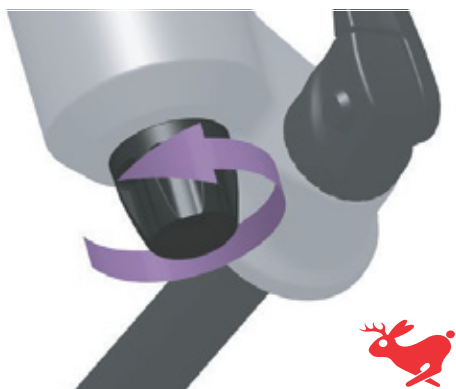
Rysunek 137: Obrócić pokrętko amortyzatora odbicia w kierunku symbolu zajaca
