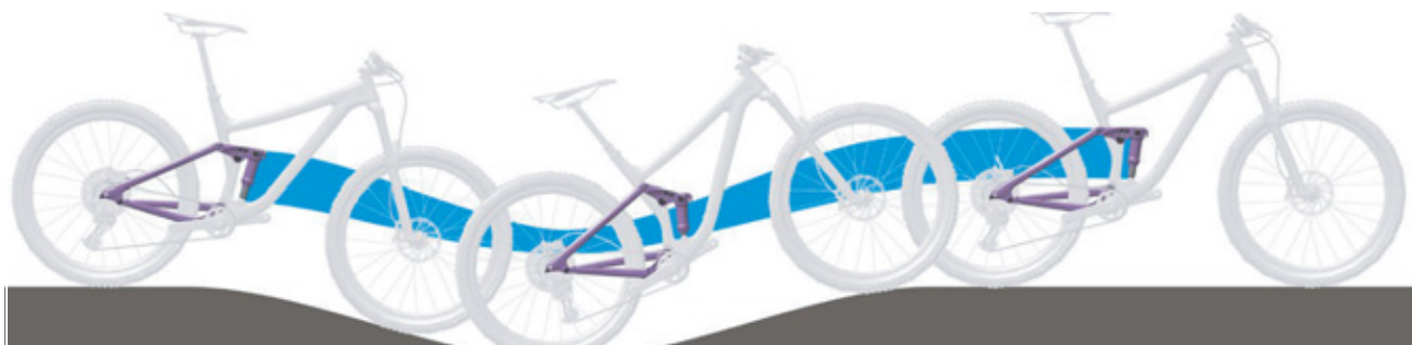
Rysunek 146: Zbyt miękkie amortyzowanie tylnego amortyzatora na wzniesieniu
