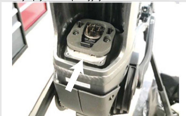
Rysunek 39: Zamontowane płytki adaptacyjne
