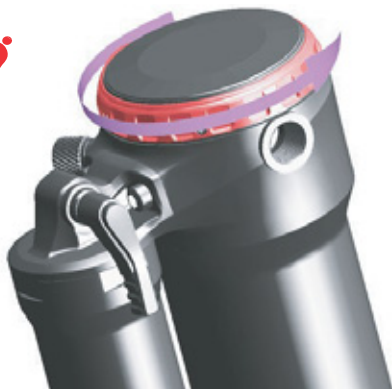
Rysunek 145: Obrócić pokrętko amortyzatora odbicia w kierunku symbolu zająca
