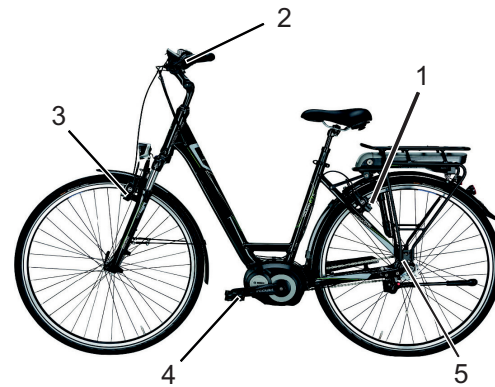
Abbildung 12: Bremssystem eines Pedelecs mit einer Rücktrittbremse, Beispiel
