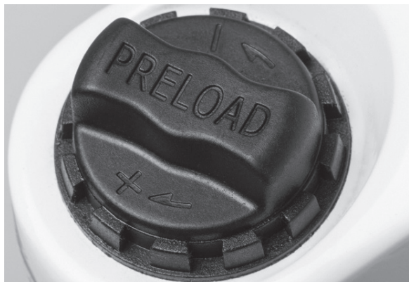
Abbildung 60: Einstellrad des Negativen Federwegs auf der Krone der Federgabel
