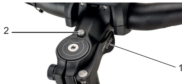
Abbildung 72: Vorbau, Ausführung II mit Spannhebel des Vorbau-Schnellspanners (1) und Entsperrknopf (2)
