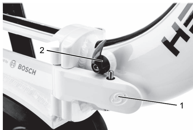
Abbildung 88: Geschlossener (1) und geöffneter (2) Rahmen-Sicherungshebel
