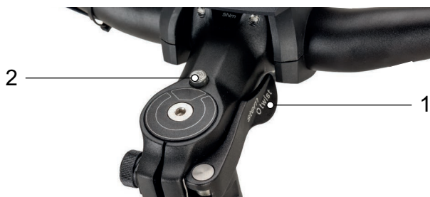
Abbildung 87: Vorbau, Ausführung II mit Spannhebel des Vorbau-Schnellspanners (1) und Entsperrknopf (2)
