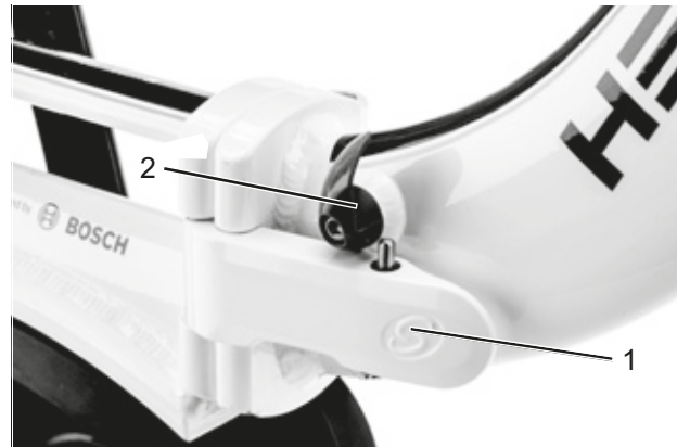
Figura 88: Palanca de seguridad del cuadro cerrada (1) y abierta (2)
