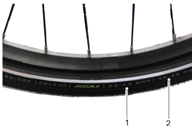
Figura 98: Presión de inflado en bar (1) y psi (2)
