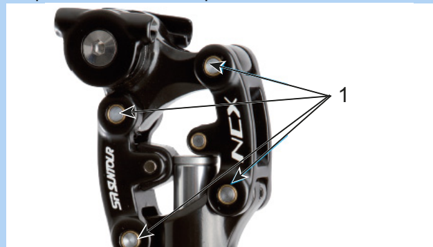
Figura 111: Puntos de lubricación de la tija de sillín de muelle SR Suntour
