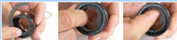
Figura 125: Inserción del anillo de fieltro
