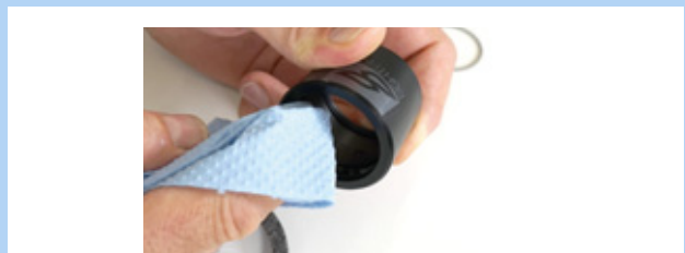
Figura 124: Limpieza del manguito exterior
