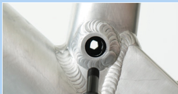
Figura 172: Orificio de la interfaz Postpin
