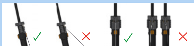
Figura 139: Cable Bowden correcto e incorrecto
