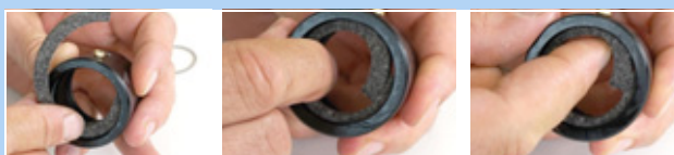
Figura 160: Inserción del anillo de fieltro
