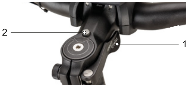
Figura 87: Potencia, versión II con palanca tensora del cierre rápido de la potencia (1) y botón de desbloqueo (2)
